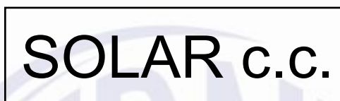
Figura A.1 – Exemplo de sinalização exigida em caixas de junção
